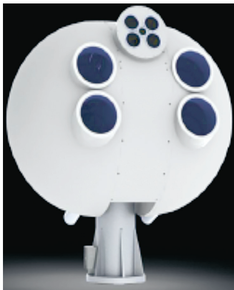
Рис. 8. Наземный терминал оптической космической связи проекта LLCD, НАСА
